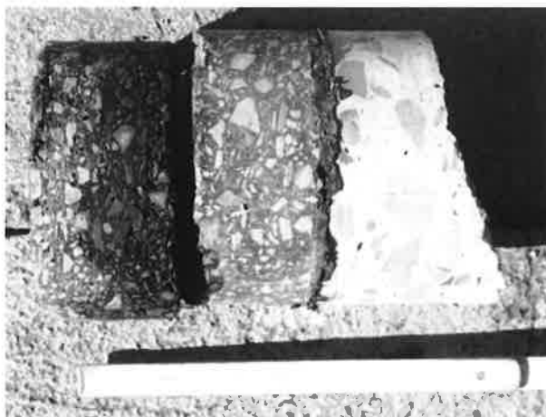
Obrázek č. 33: Skladba mostního svršku v části s podélným spádem 5 % při OP2
