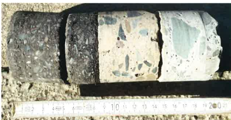
Obrázek č. 35: Skladba mostního svršku ve střední části bez podélného spádu – patrné je asfaltové souvrství s AIP a vrstvou vyrovnávacího betonu následovaného betonem mostovky
