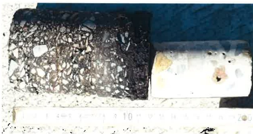
Obrázek č. 34: Skladba mostního svršku v části s podélným spádem 5 % při OP1 – patrné je asfaltové souvrství s AIP a vrstvou vyrovnávacího betonu
